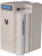
[1차수 제조장치] (RO수) 상수에서 1차수 제조 시스템
