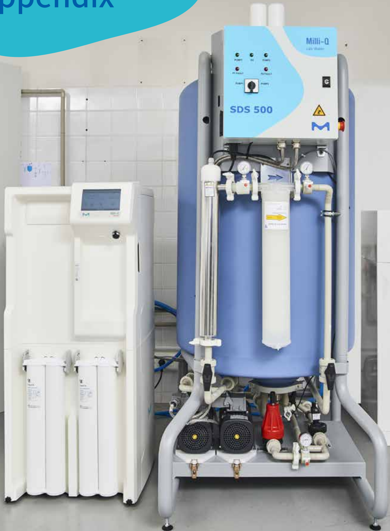
SDS 500과 페어링된 Milli-Q® HX 7000 시리즈 시스템
