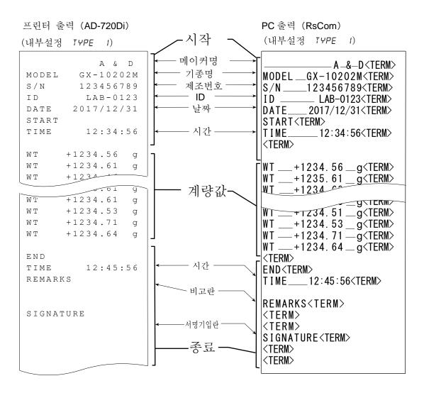
공백 ASCII 20h。<TERM>터미네이터 Cr Lf 또는 Cr .Cr 캐리지 리턴, ASCII 0Dh.Lf 라인피드 ASCII 0Ah.
