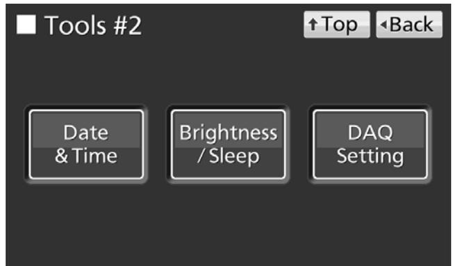
4. DAQ 설정 화면에서, DAQ 의 각 설정을 할 수 있습니다. 설정에 대한 자세한 사항은, Data Acquisition System MTR-5000 의, 기기설정순서서를 참조해 주십시오. Apply 키를 눌러 입력 값과 설정을 저장하십시오. 화면은 Tools#2 화면으로 돌아갑니다.
